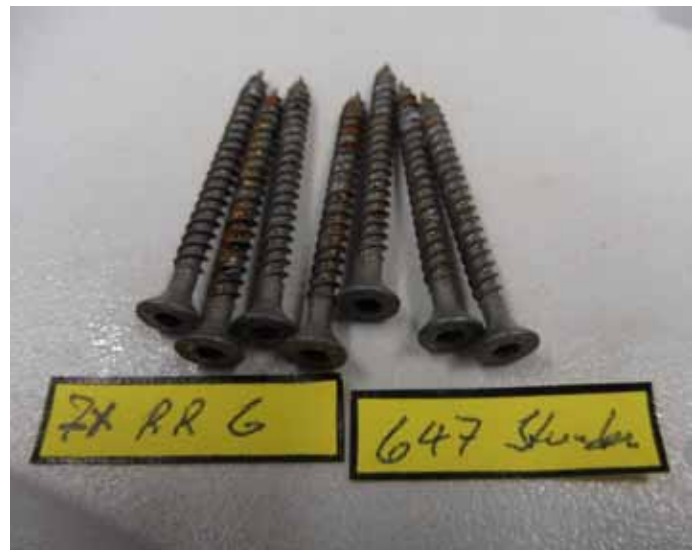
Schrauben mit ALZ-Beschichtung nach 647 Stunden im SST
