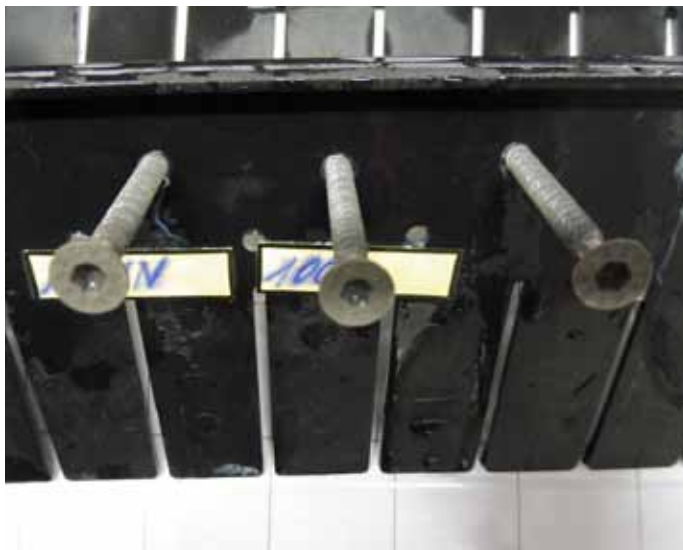
Schrauben mit ALZ-Beschichtung nach 456 Stunden im SST
